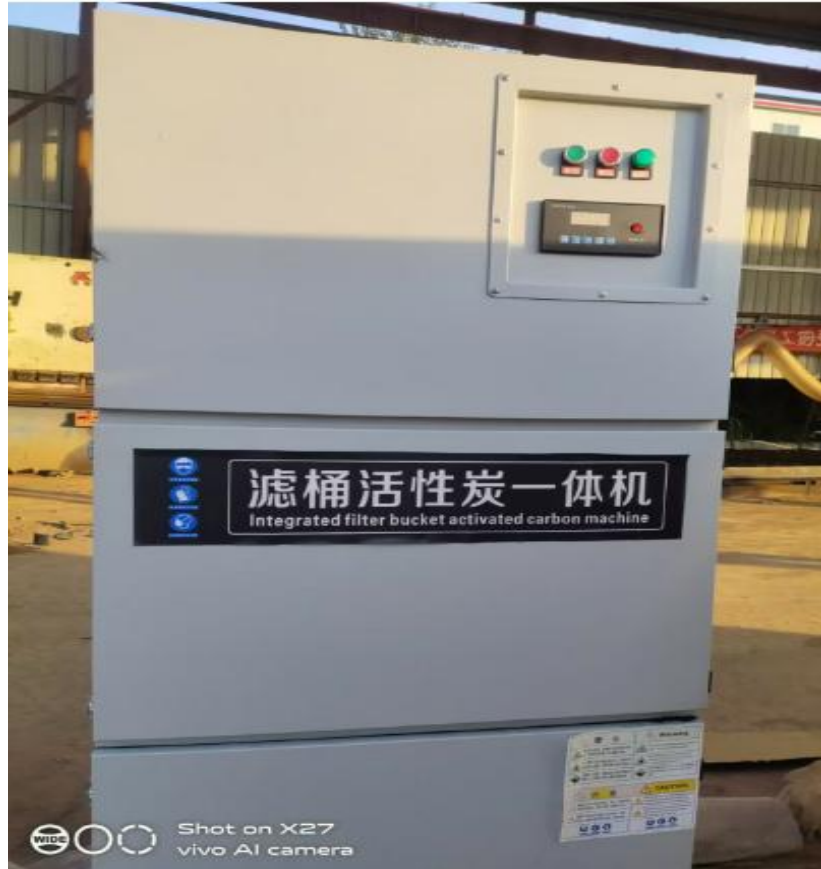
船台区补漆废气移动式“干式过滤+活性炭”处理装置
