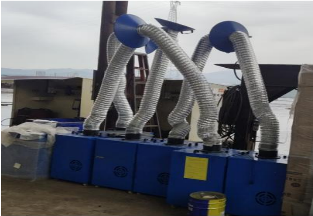
厂区移动式除尘装置
