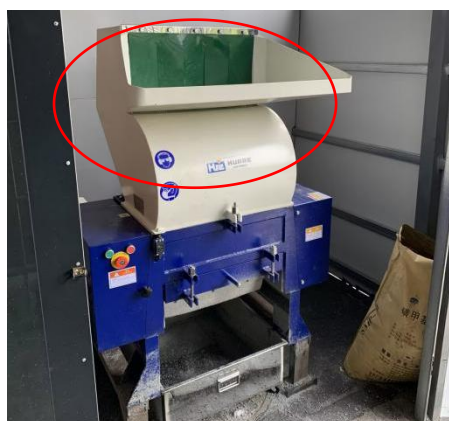
破碎机进、出料口防尘帘
