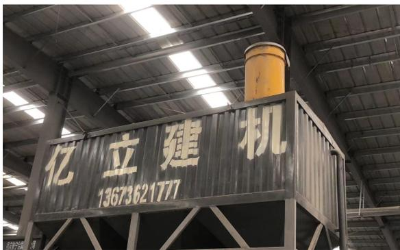
30m<sup>3</sup> 水泥筒仓仓顶除尘器
