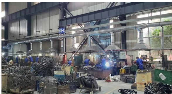
焊接烟尘收集措施
